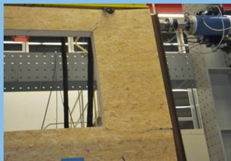
Die Traglastversuche stießen auf reges Interesse: Von rechts wirkt horizontal eine Kraft von über 7 Tonnen auf die Holzrahmenkonstruktion, bevor sie versagt
